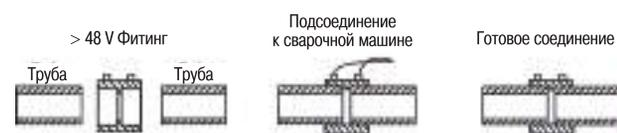
Универсальный сварочный аппарат для электромуфтовой сварки фитингов с закладным нагревательным элементом из ПЭ и ПП в диапазоне 8 – 48 В и < 1200 мм
